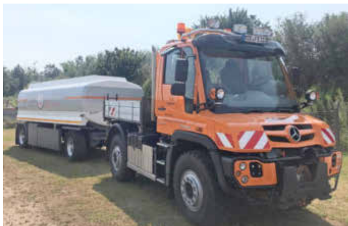
17.800 Liter Fassungsvermögen - der mobile Tanklöschanhänger Foto: Benjamin Schworm
